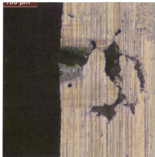
Links ist eine der Fehlerstellen im Querschliff unter dem Mikroskop zu sehen. Das Bild rechts zeigt einen Detailausschnitt unter dem Elektronenmikroskop. Form und Ausprägung sind typisch für Lochkorrosion.
