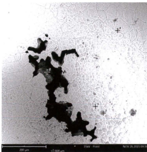
Links ist eine der Fehlerstellen im Querschliff unter dem Mikroskop zu sehen. Das Bild rechts zeigt einen Detailausschnitt unter dem Elektronenmikroskop. Form und Ausprägung sind typisch für Lochkorrosion.
