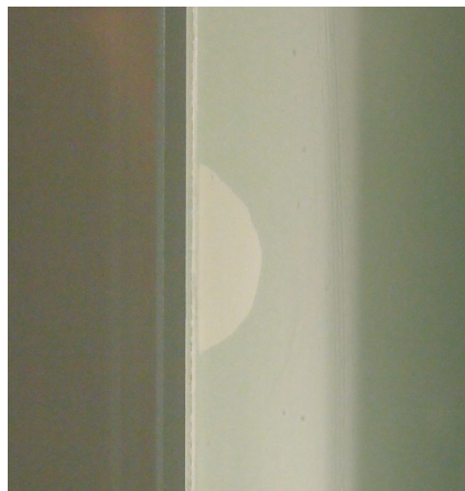
Bild 3 > Der falsche Lack: Glasbeschichtung erfordert einen Haftvermittler, ohne ihn kommt es zu Schäden, wie dem Eindringen von Feuchtigkeit zwischen Glas und Beschichtung.
