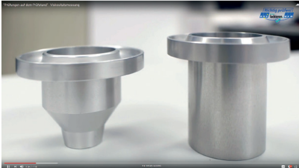
Ausschnitt aus dem Video „Prüfungen auf dem Prüfstand“ – Die Norm für den Auslaufbecher DIN 4 (links) gilt nicht mehr. Foto: Redaktion
