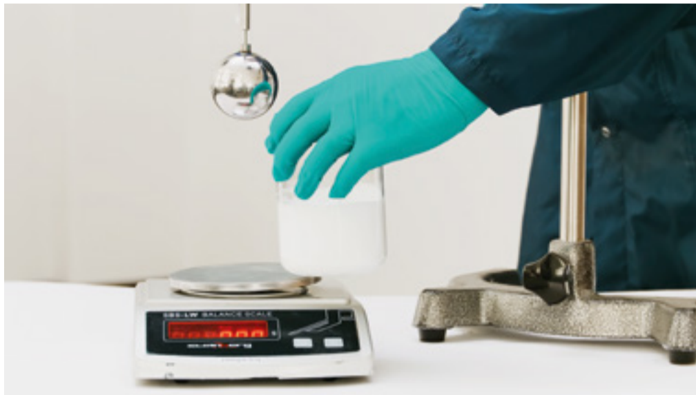
Die Dichte des Lacks kann relativ einfach bestimmt werden. Für Lacke sind die Methoden mittels Pyknometer oder Tauchkörper-Verfahren gemäß DIN EN ISO 2811-1 bzw. -2 ausreichend genau. Hier wird die Dichte mittels 100 ml-EIC-Kugel, Analysenwaage und Thermometer ermittelt. Fotos: Redaktion
