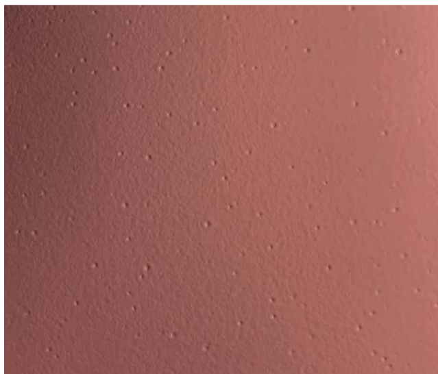
Die Krater zeigten sich ausschließlich in einer Lackieranlage, andere waren nicht betroffen. Foto: DFO
