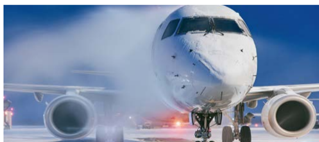
Sind die Tragflächen eines Flugzeuges vereist, müssen sie langwierig enteist werden. Neu entwickelte Beschichtungen schützen langanhaltend vor Eis. Foto: Adobe Stock Chalabala
