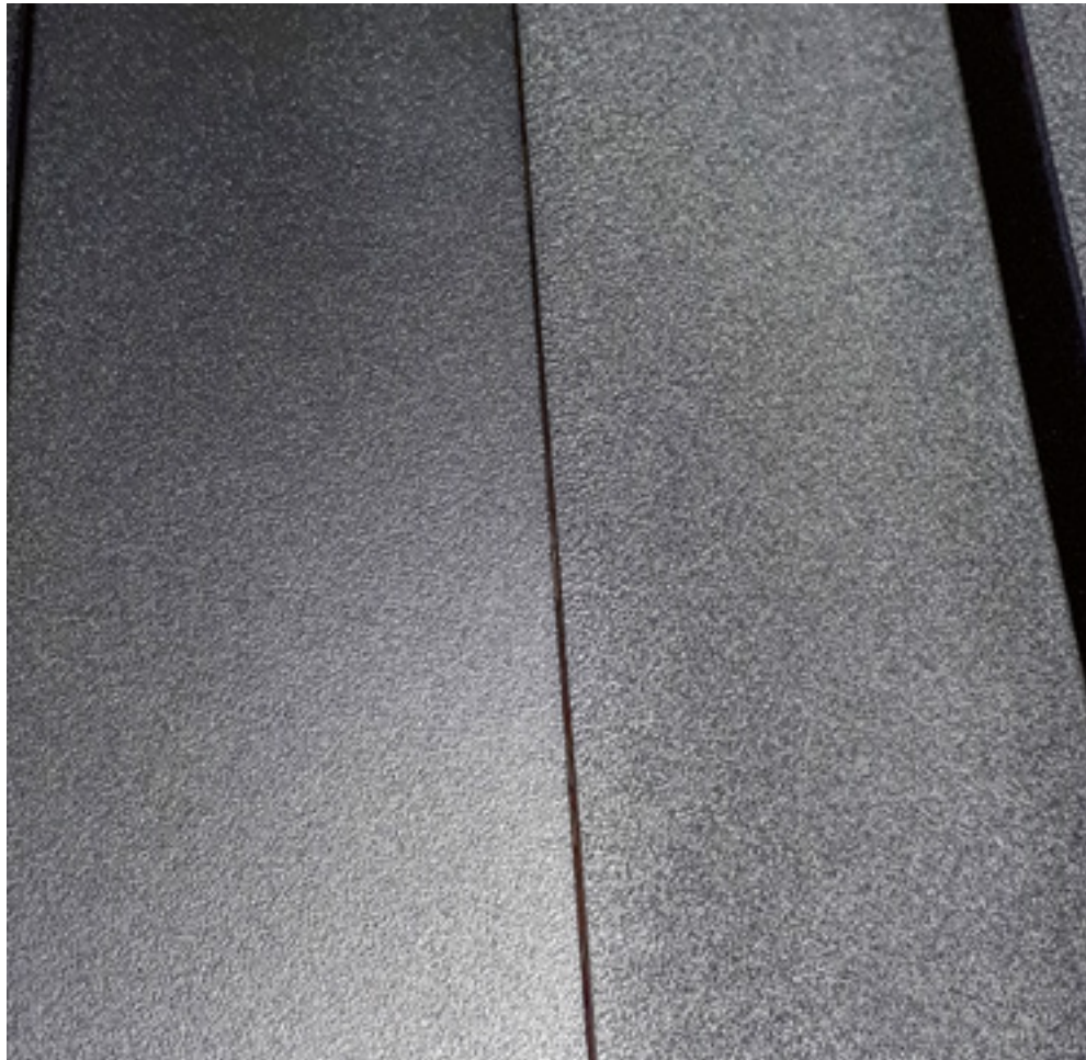
Die Strukturunterschiede sind mit dem bloßen Auge zu erkennen. Abweichungen der Schichtdicke können zu solchen Effekten führen.
