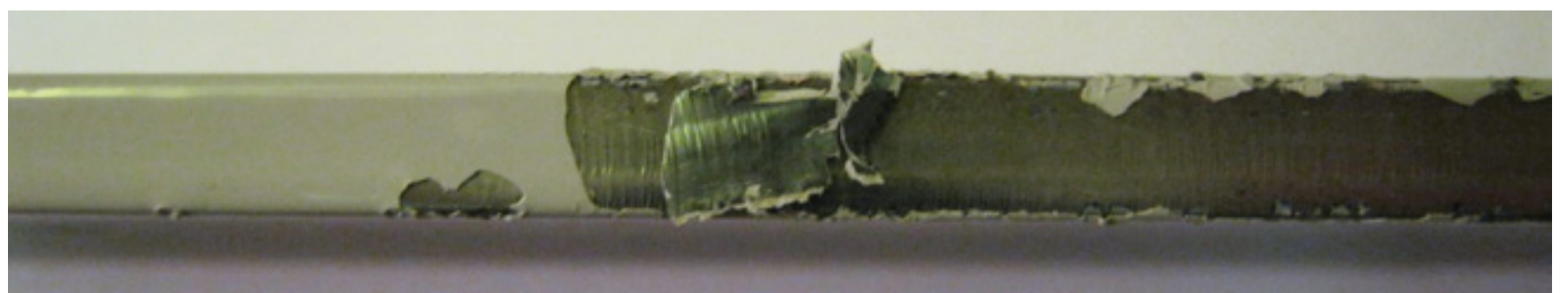
Die schwarze Zunderschicht führt zum Abplatzen des Lacks (unten) und ist schon mit dem Auge deutlich zu sehen (oben).
