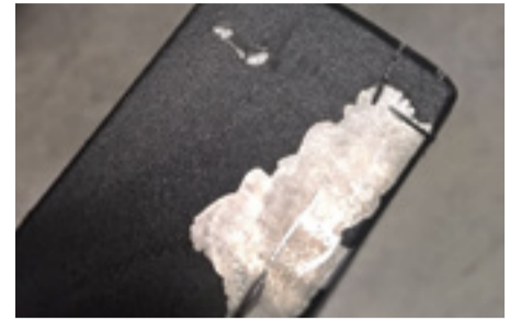
Blasenbildung, Abplatzen, Haftfestigkeitsverluste – nur einige der Herausforderungen der Beschichtung. Foto: DFO
