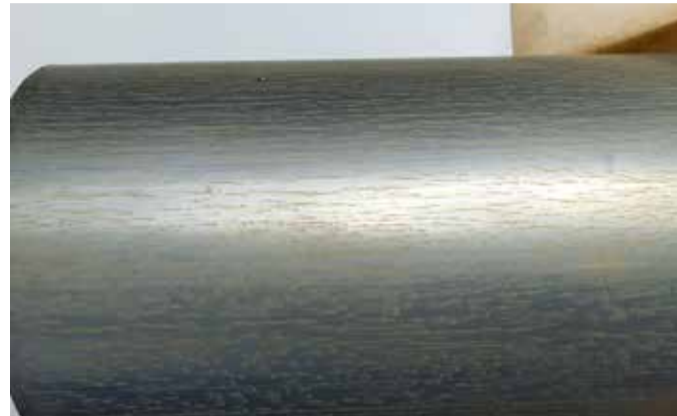
Abbildung 2: Mit dem bloßen Auge waren auf dem unbeschichteten vorbehandelten Bauteil Ablagerungen sichtbar.
