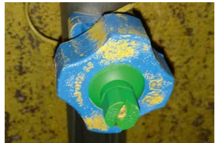
Spritzdüsen sollten bestenfalls täglich kontrolliert werden, damit sie nicht verstopfen.
