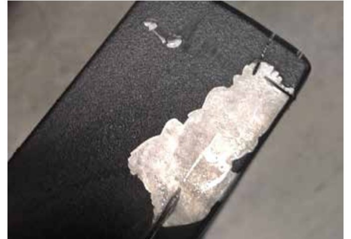
So soll es nicht sein: Eine schlechte Haftfestigkeit kann dazu führen, dass Lack abplatzt.
