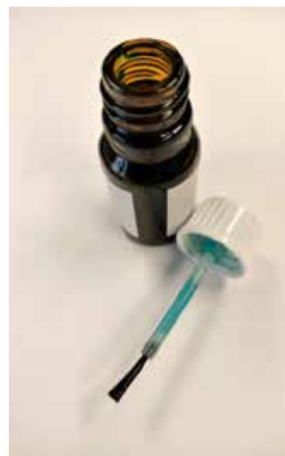
Die mehrfache Anwendung des Pinsels führt zu Verschmutzungen der Testtinte.
