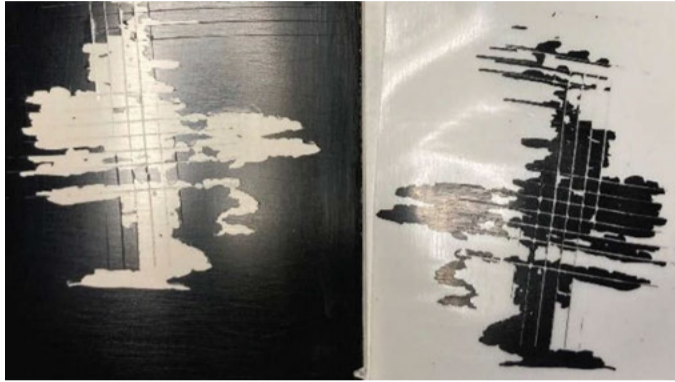
Im Rahmen der Gitterschnittprüfung löste sich die schwarze IMC-Schicht großflächig vom Untergrund.
