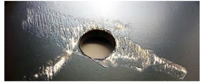
Bild 1: Die Benetzungsfehler traten nur im Bereich von Bohrungen auf, hier zu sehen ist die Draufsicht der Fehlerstelle. Quelle (zwei Bilder): DFO
