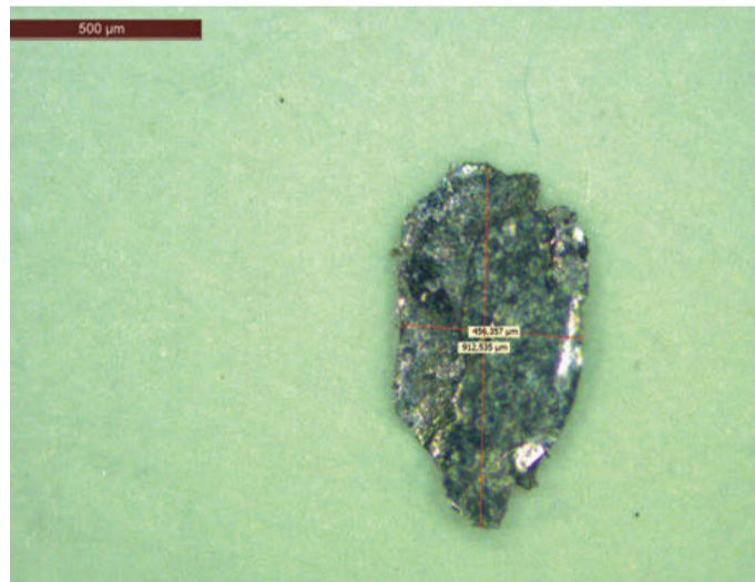
Im Lackmaterial konnten Eisenpartikel identifiziert werden.
